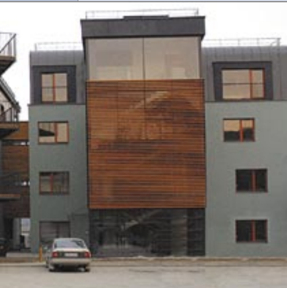
Daugiabutis namas Žvėryne. Medžio-stiklo fasadų sistema su apsauginėmis žaliuzėmis
